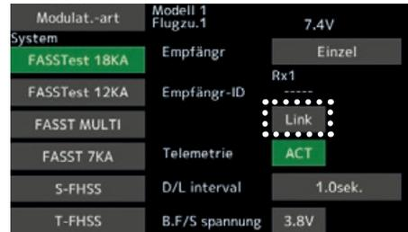
7. Sobald der Sender die Melodie sendet, Spannungsversorgung des Empfängers einschalten. Der Empfänger sollte innerhalb ca. 1 Sek. an den Sender angebunden sein.
