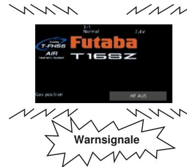
Bei Ertönen des Warnsignals Gashebel nach hinten ziehen, und erst dann Empfänger EIN.
