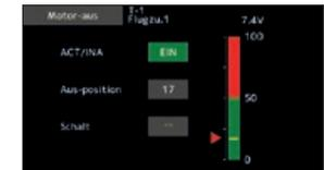
„Wenn der Gashebel in Leerlaufposition ist, Abschaltposition einstellen, bis der Motor dauerhaft AUS ist; aber die Gashebelanlenkung nicht blockiert.“
